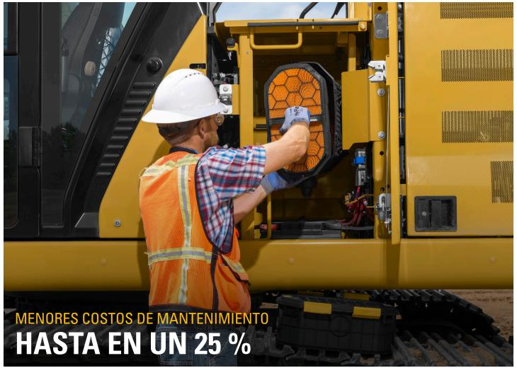
Con intervalos de mantenimiento sincronizados y extendidos, puede hacer más trabajo a un costo menor en comparación con la 330D2. Los lugares consolidados de los filtros permiten que el servicio sea más rápido. Los filtros hidráulicos, de aire y del depósito de combustible tienen mayor capacidad y una vida útil más duradera. El acceso al manual de operación y mantenimiento es fácil a través del monitor que se encuentra en la cabina.
