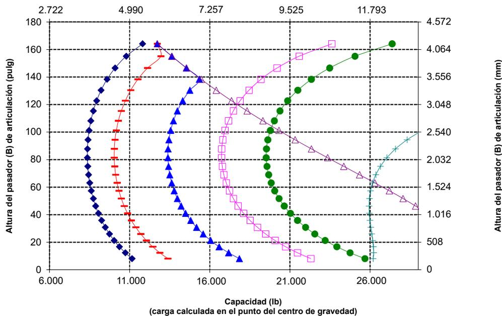
**NOTA:** Los valores de carga límite de equilibrio estático y peso en orden de trabajo se basan en la siguiente configuración del cargador: neumáticos Bridgestone VJT L4, aire acondicionado, control de amortiguación, protector del tren de fuerza, depósitos de fluidos llenos, tanque de combustible, refrigerante, lubricantes y operador.
