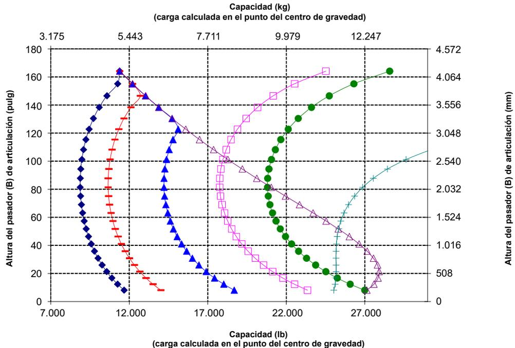
**NOTA:** La carga límite de equilibrio estático y el peso en orden de trabajo se basan en la siguiente configuración del cargador: neumáticos Bridgestone VJIT L3, aire acondicionado, control de amortiguación, protector del tren de fuerza, depósitos de fluidos llenos, tanque de combustible, refrigerante, lubricantes y operador.
