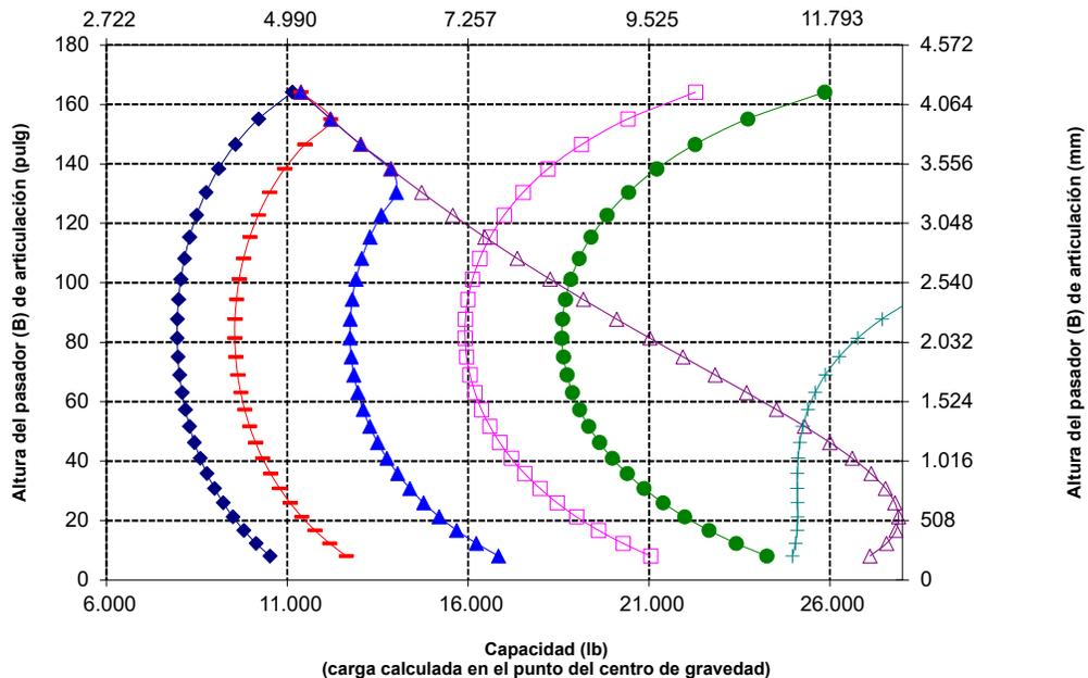
**NOTA:** La carga límite de equilibrio estático y el peso en orden de trabajo se basan en la siguiente configuración del cargador: neumáticos Bridgestone VJT L3, aire acondicionado, control de amortiguación, protector del tren de fuerza, depósitos de fluidos llenos, tanque de combustible, refrigerante, lubricantes y operador.
