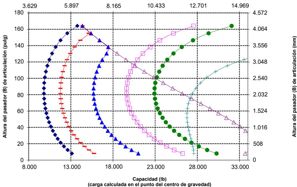
**NOTA:** La carga límite de equilibrio estático y el peso en orden de trabajo se basan en la siguiente configuración del cargador: neumáticos Bridgestone VJL L3, aire acondicionado, control de amortiguación, protector del tren de fuerza, tanques de fluidos llenos, tanque de combustible, refrigerante, lubricantes y operador.
