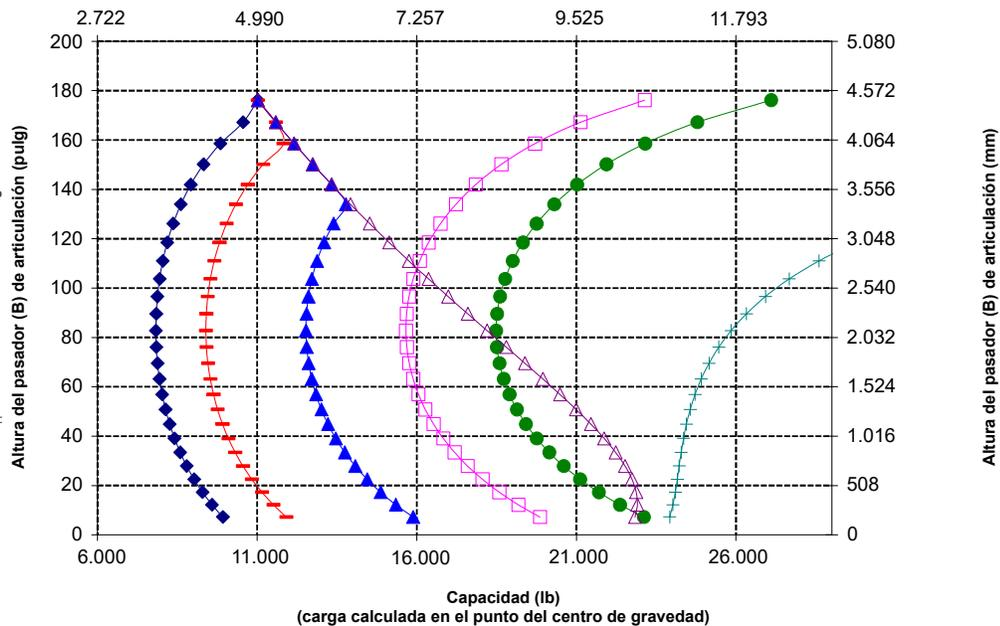
**NOTA:** La carga límite de equilibrio estático y el peso en orden de trabajo se basan en la siguiente configuración del cargador: neumáticos Bridgestone VIT L3, aire acondicionado, control de amortiguación, protector del tren de fuerza, depósitos de fluidos llenos, tanque de combustible, refrigerante, lubricantes y operador.
