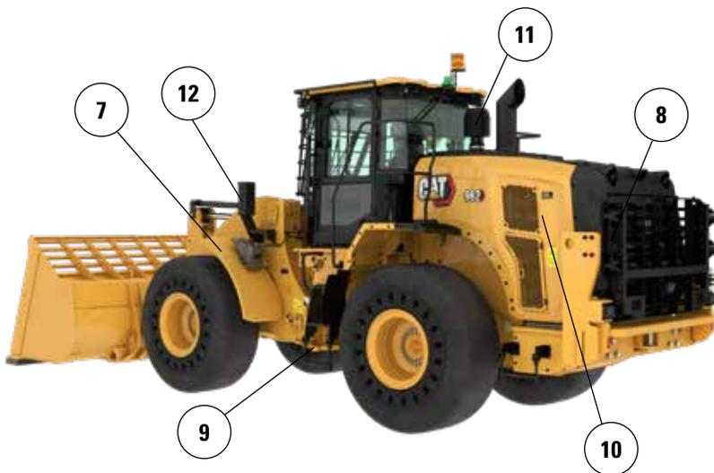
7. Los guardabarros delanteros estrechos de acero ayudan a mantener el parabrisas limpio y se colocan en el interior del borde exterior del neumático para una mayor protección.
