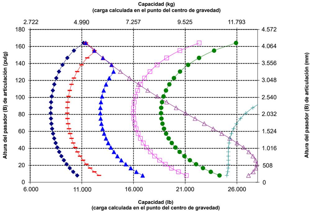
**NOTA:** La carga límite de equilibrio estático y el peso en orden de trabajo se basan en la siguiente configuración del cargador: neumáticos Bridgestone VJT L3, aire acondicionado, control de amortiguación, protector del tren de fuerza, depósitos de fluidos llenos, tanque de combustible, refrigerante, lubricantes y operador.
