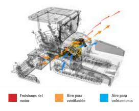
Las emisiones del motor se dirigen hacia afuera por encima de la tolva. Cuando la máquina está equipada con el sistema de ventilación optativo, el aire del túnel transportador y de la cámara del sinfín sigue una trayectoria similar y se redirige lejos del operador para que el entorno de trabajo sea más cómodo.
