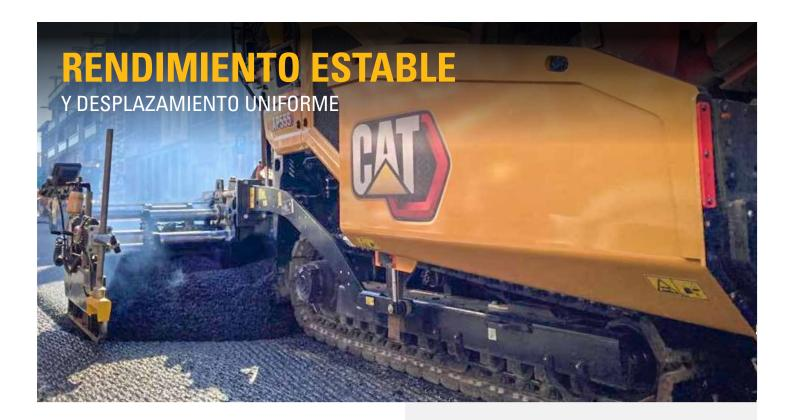
Los modelos de cadenas de acero cuentan con las mismas excelentes características utilizadas en las versiones Mobil-Trac con velocidades de desplazamiento levemente menores. Este diseño estable utiliza un sistema de tensión automática para obtener un rendimiento de tracción superior y reducir al mínimo el desgaste.
