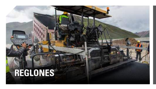
Los reglones Cat ofrecen excelente durabilidad, ajuste fácil y mantenimiento sencillo. El reemplazo simple de los elementos de calefacción y los bastidores del reglón maquinados facilitan las revisiones rápidas y disminuyen los costos de operación.
