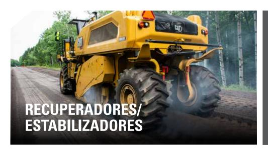
Los recuperadores de caminos y estabilizadores de suelos Cat pulverizan la capa de asfalto y la mezclan con la base subyacente o mezclan aditivos y agregados en el suelo para estabilizar las carreteras o suelos deteriorados a fin de crear una base fuerte.
