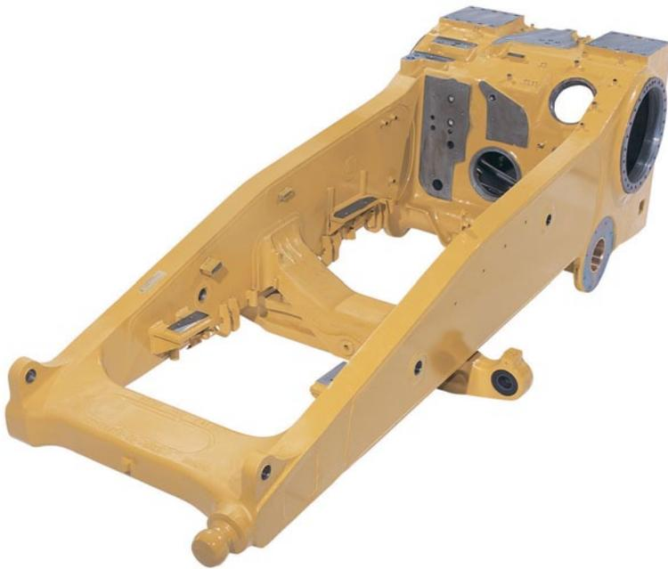
El nivel de resistencia con que se fabrica el bastidor principal del modelo D8T es líder en la industria; las fundiciones de acero pesado, los rieles de bastidor de sección total en caja y las secciones de enrollado continuo en los rieles del bastidor superior y del bastidor inferior proporcionan la resistencia necesaria para absorber las altas cargas de impacto y las fuerzas de torsión.
