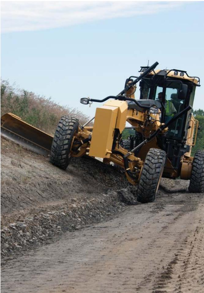
Si su trabajo se realiza en condiciones de terreno inconsistente en las que la fuerza de arrastre puede representar un desafío, la función opcional de tracción en todas las ruedas (AWD) le puede proporcionar el empuje adicional que usted necesita sobre el suelo, para trabajar de manera más eficaz en el fango, la grava, la arena o la nieve. La fuerza de tracción adicional contribuye a reducir la acción de deslizamiento en taludes laterales.
