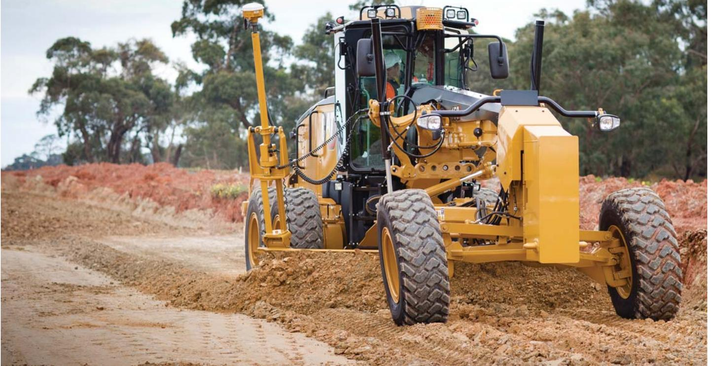
Los motores Cat C7 y C9 le ofrecen el tipo de funcionamiento que usted requiere, para conservar velocidades que permitan una nivelación uniforme y lograr así el máximo rendimiento. Un extraordinario par de torque y la gran capacidad de sobrecarga del motor, generan la potencia necesaria para la recuperación ante incrementos de exigencia repentinos y transitorios.
