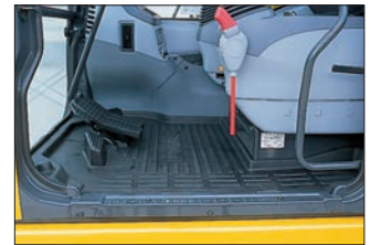
Palanca de cierre está en la Posición Bloqueo
