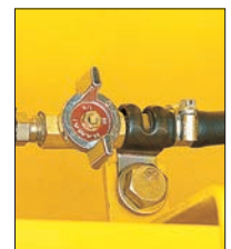
Válvula de Drenaje de Combustible
