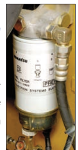
Válvula de Drenaje de Combustible
