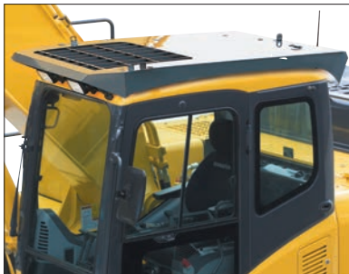
Protectores de Protección del Operador (OPG) Nivel 2 Con Protector Superior (opcional)
