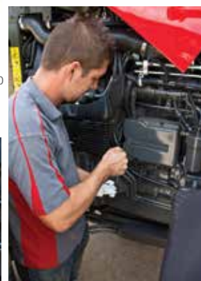
● El capó esbelto y el diseño del eje delantero aseguran un cómodo acceso a los filtros de aceite del motor y las varillas del nivel del aceite
