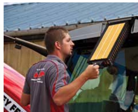
● El filtro de aire de la cabina se puede retirar fácilmente para su limpieza
