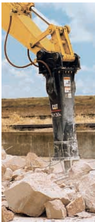
Martillos hidráulicos Cat. Los martillos hidráulicos Cat producen un golpe muy fuerte que se transfiere de la herramienta a la roca. En aplicaciones mayores, la herramienta roma no penetra la superficie de la roca; transmite una onda de tensión que rompe los cristales de roca.
