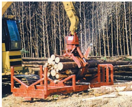
Herramienta cortadora. Las herramientas cortadoras de serrerías se usan, por lo general, en aplicaciones que requieren alta productividad y eficiencia, en árboles que se cortan a longitudes especificadas.
