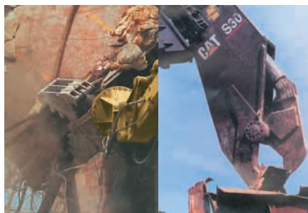
Cizallas para chatarra. Las cizallas para chatarra se recomiendan para cortar materiales metálicos y no metálicos en parques de chatarra.
