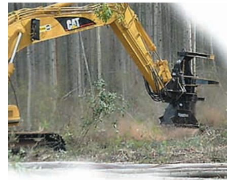
Talador apilador. Con la capacidad de cortar y acumular un número de árboles durante la operación de talado, proporciona alta productividad y rapidez en bosques plantados.
