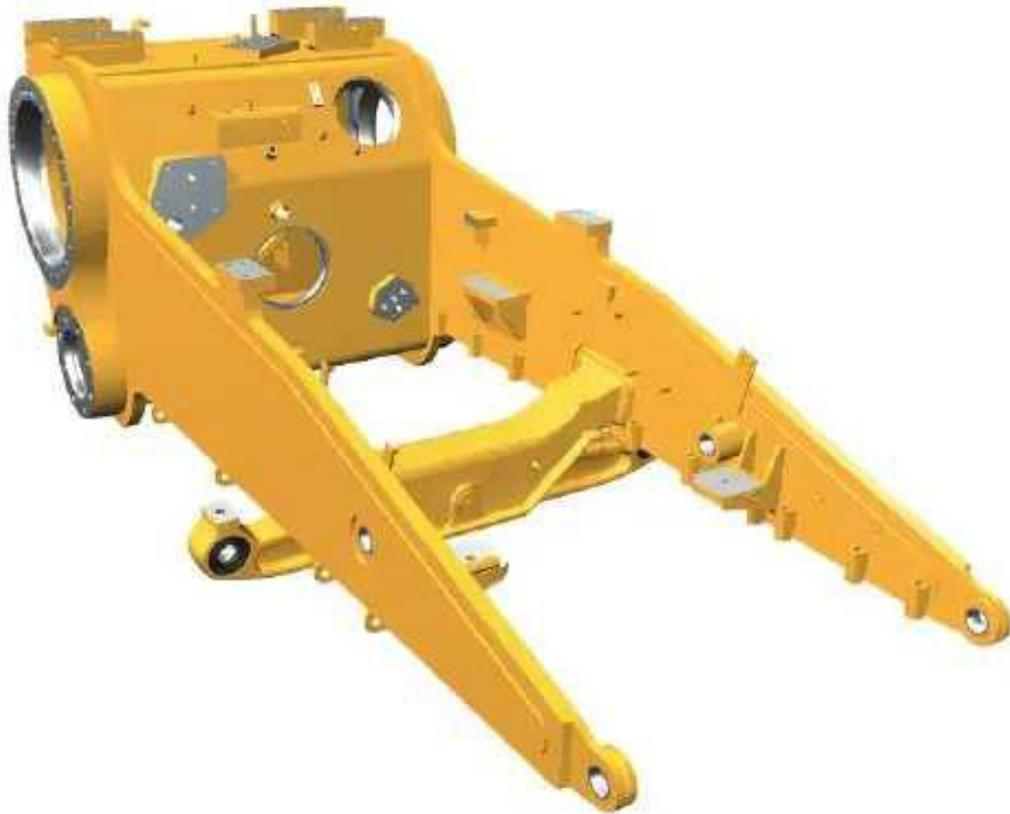
**Bastidor y fundiciones.** El bastidor del D6R II está construido para absorber las cargas de choque de alto impacto y las fuerzas de torsión. Se agregan fundiciones para proporcionar fortaleza adicional a la caja principal.
