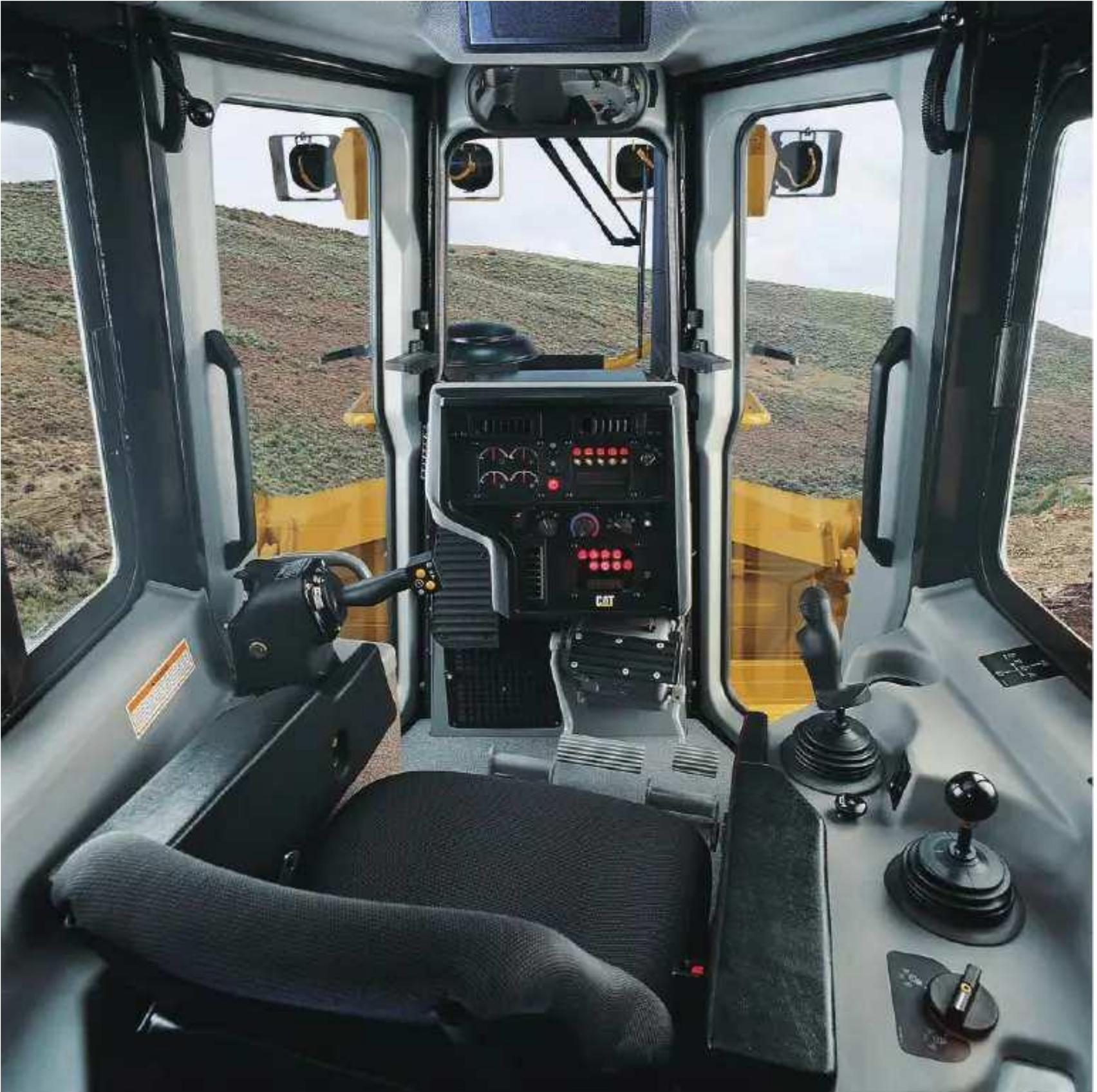
**Cabina.** Cabina presurizada de montaje aislado que reduce el ruido y la vibración y aumenta la comodidad del operador.
