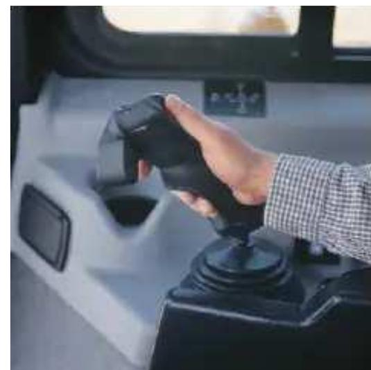
**Controles de las herramientas.** El D6R II tiene controles de la hoja y del desgarrador de diseño ergonómico, con sistema hidráulico piloto de bajo esfuerzo que aumenta la comodidad del operador,
