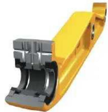
**Barra compensadora.** La barra compensadora fijada con pasadores permite que los bastidores de rodillos inferiores oscilen hacia arriba o hacia abajo para adaptarse mejor al contorno del terreno a la vez que proporciona máxima tracción y comodidad del operador. La barra compensadora, con las juntas de pasadores de extremo llenadas con aceite, optativas, y sellos de deslizamiento limitado, duran más en aplicaciones severas y reducen los costos de reparación.
